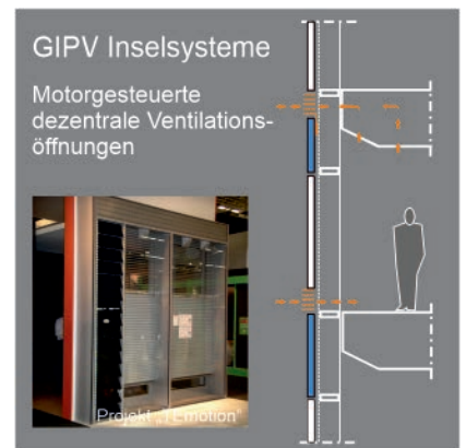
Abb. 4.4.1-02: Ventilationssysteme mit PV
