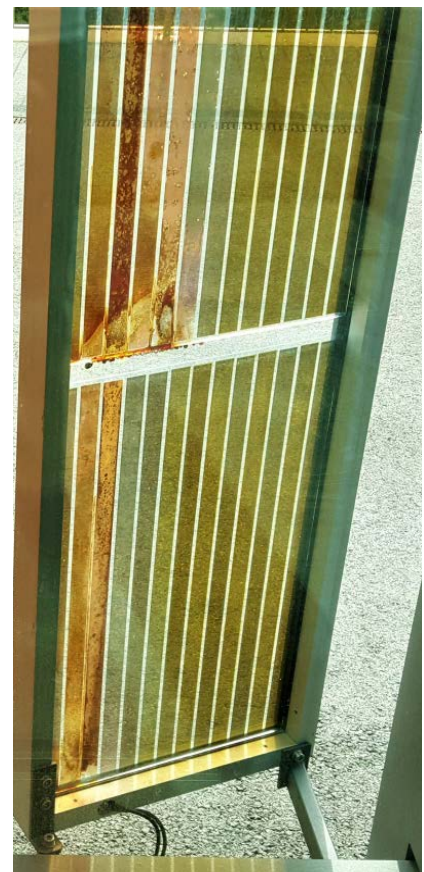
Abb. 9-02: Farbstoffsolarmodul mit Problemen der Langzeitstabilität
