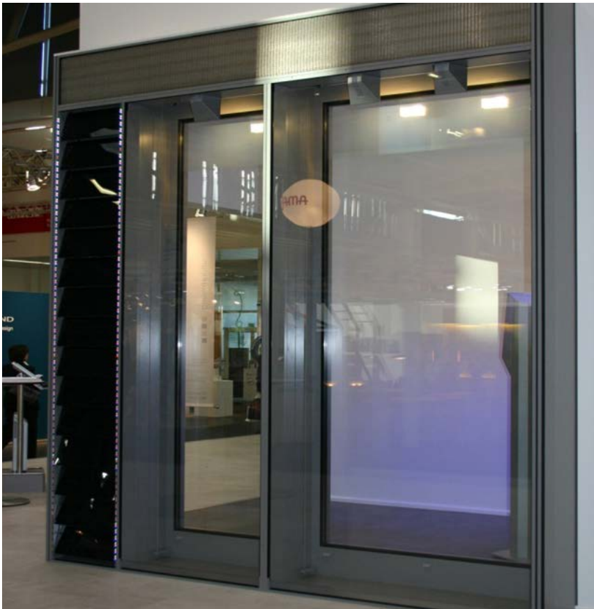
Abb. 6.1-05: Testfassade, „Autarc Facade – TEmotion“ mit integrierter Photovoltaik
