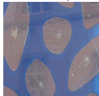
Abb. 7.7.2-02: Vorderseite der in die ETFE Folien integrierten OPV-Zellen
